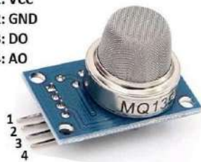
Mq135 pin diagram
