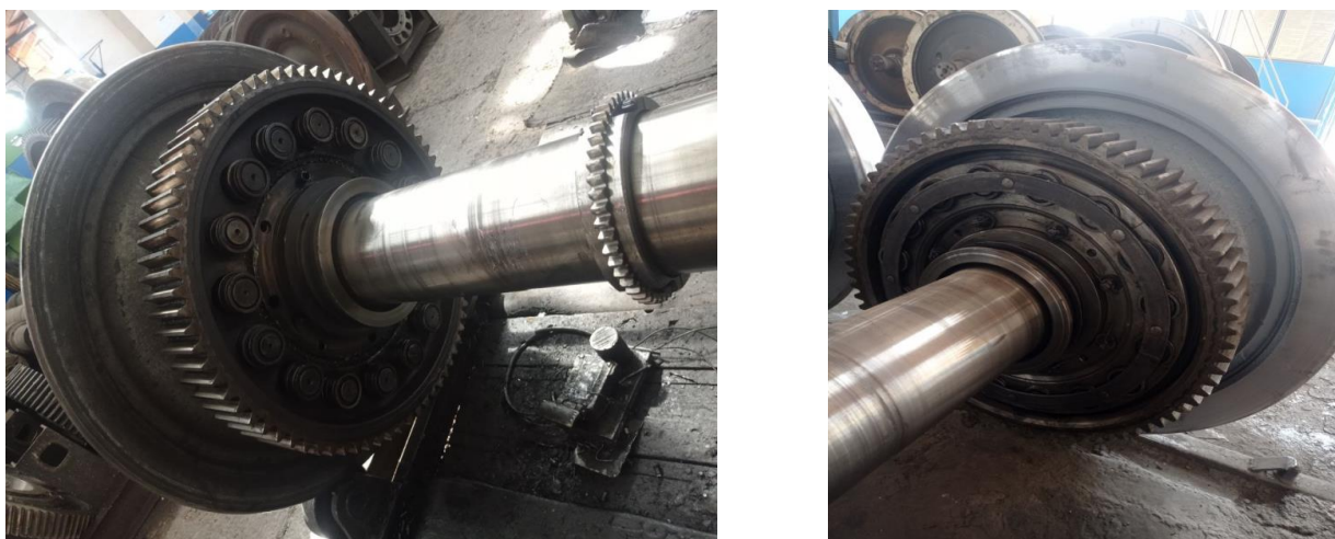
1 - rasm. Magistral teplovozlarning g'ildirak-motor blokida yig'ma konstruksiyali tishli g'ildirak
