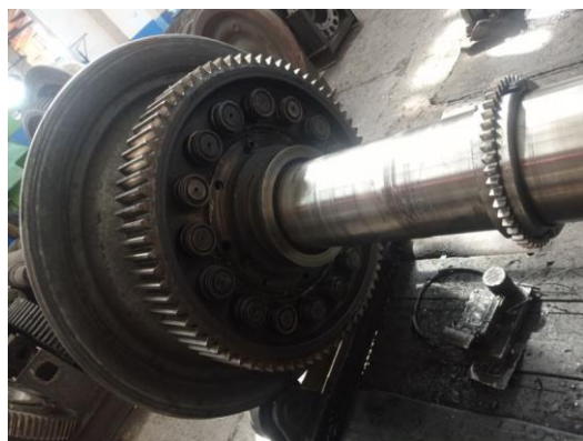
1 - rasm. Magistral teplovozlarning g'ildirak-motor blokida yig'ma konstruksiyali tishli g'ildirak
