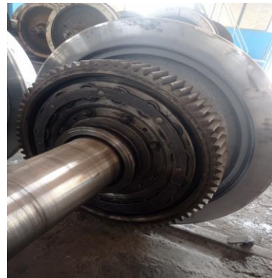
1 - rasm. Magistral teplovozlarning g'ildirak-motor blokida yig'ma konstruksiyali tishli g'ildirak
