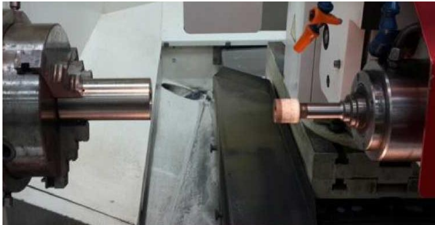
3-расм. Студер С30 дастгоҳида Ø30Н6 тешикни ички жилвирлаш
